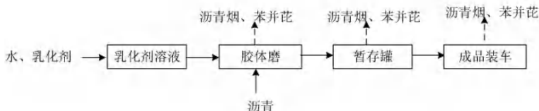
图5-4 乳化沥青生产工艺流程及产污环节图
